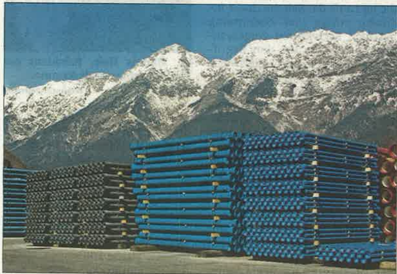
Die duktilen Rohre der TRM werden für Trink- und Abwasser sowie Beschneigungsanlagen, aber auch für Projekte im Spezialtiefbau eingesetzt.
